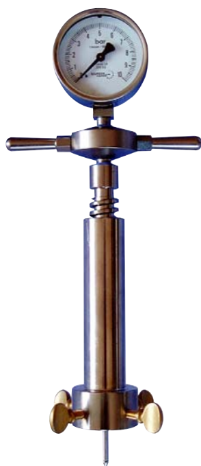
Aphromètres Aphromètres pour vins mousseux permettant de contrôler la pression interne des bouteilles après tirage. Gamme de mesure : 0/10 bars. Réf. 100100
