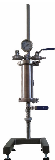
Indice de colmatatge Capacité 400ml. Permet d'estimer le pouvoir colmatant du vin. Vin filtré sur membrane 0,65 µm de porosité. Réf. 198300
