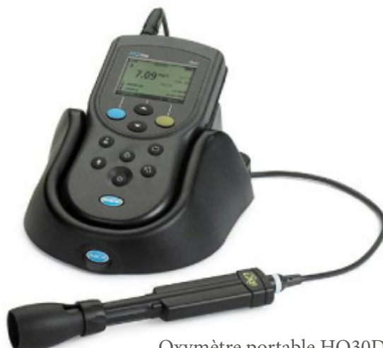
Oxymètre portable HQ30D Capteur LDO d'oxygène dissous sans dérive. Pas de polarisation à effectuer. Gamme de mesure : 0,00 à 30 mg/L. Précision : 0,01 mg/L. Compensation de la pression automatique. Réf. 195200
