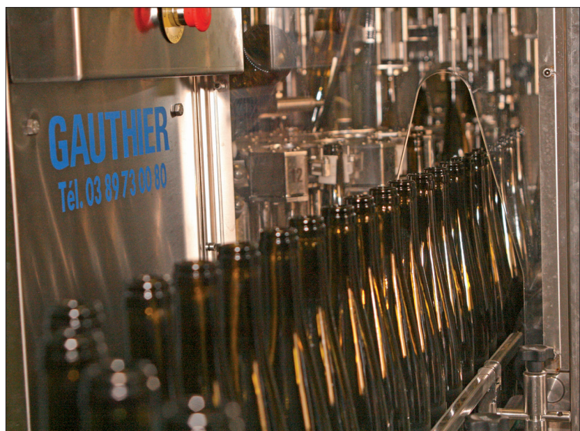
La nouvelle tireuse Gai avec inertage.
